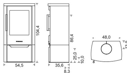
Alle Zeichnungen: Die Maße für den Rauchabgang und den Frischluftanschluss sind bis zur Mitte der Öffnung angegeben.
