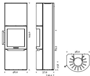
Alle Zeichnungen: Die Maße für den Rauchabgang und den Frischluftanschluss sind bis zur Mitte der Öffnung angegeben.
